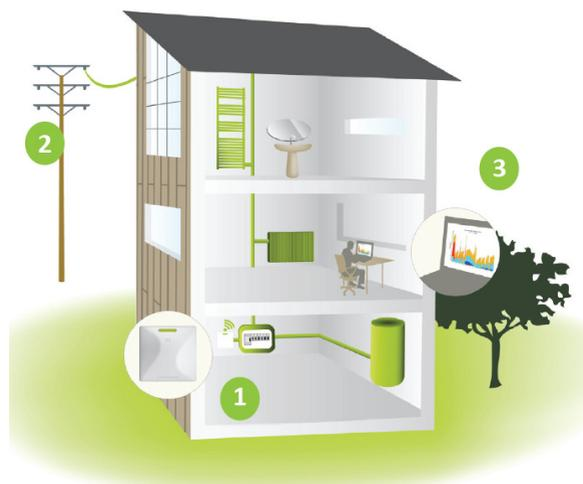
**1** Le boîtier installé **gratuitement** chez vous permet de piloter vos radiateurs et chauffe-eaux, réalisant ainsi des économies d'énergie, sans compromis de confort.
